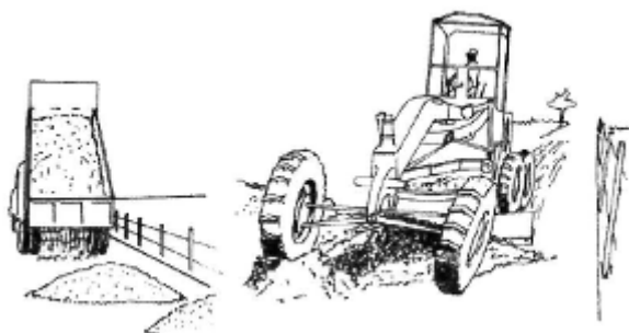
Figura 17 - Execução do revestimento na via.
