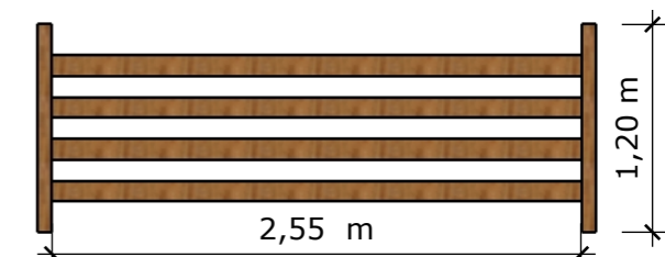
DETALHAMENTO GUARDA CORPO ESC: 1/40
